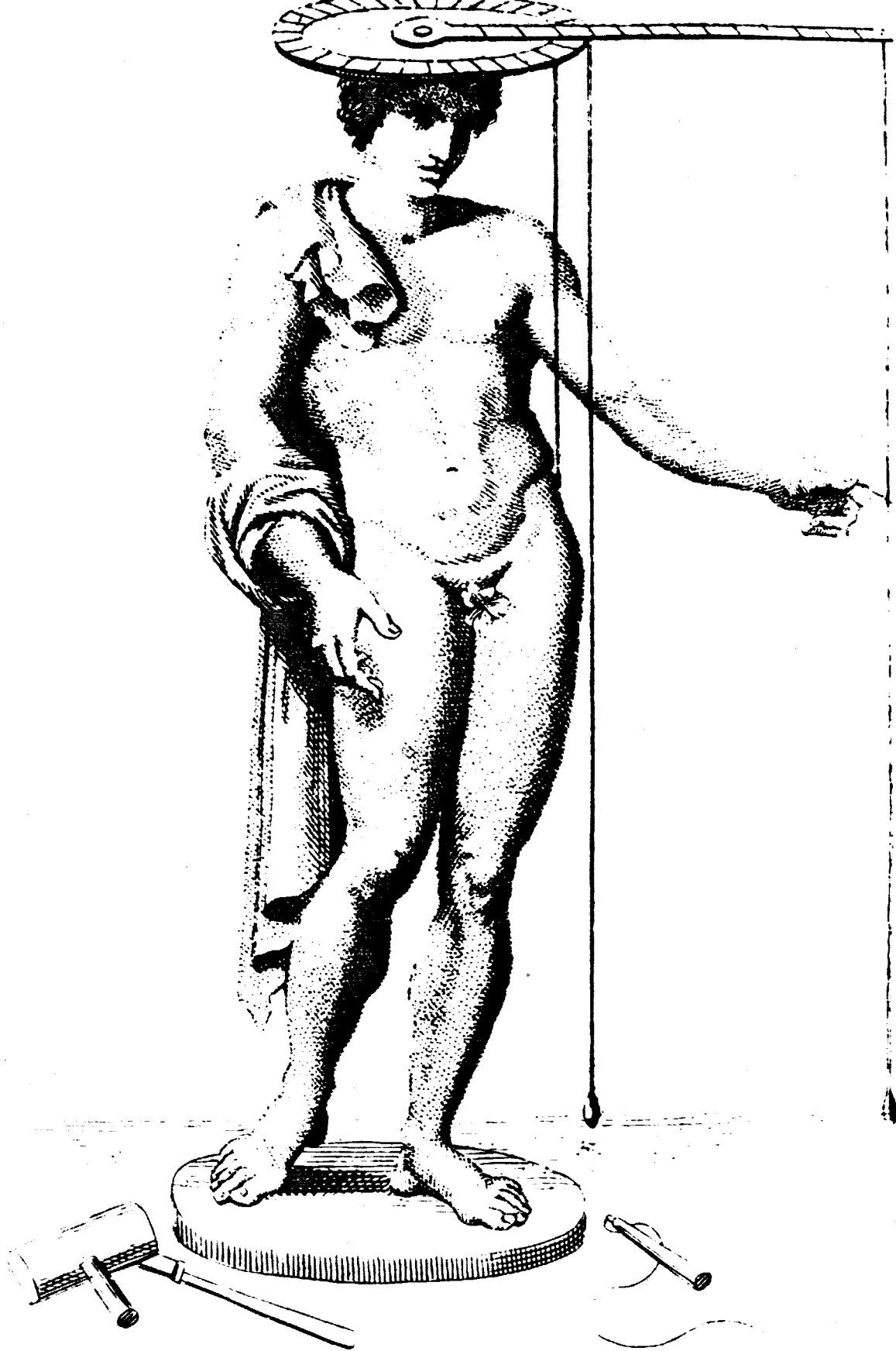
Figura 15. Definitor de L.B. Alberti; siglo XV. Instrumento construido para trasladar las medidas del modelo al bloque de piedra, basado en el sistema de plo- mada.
