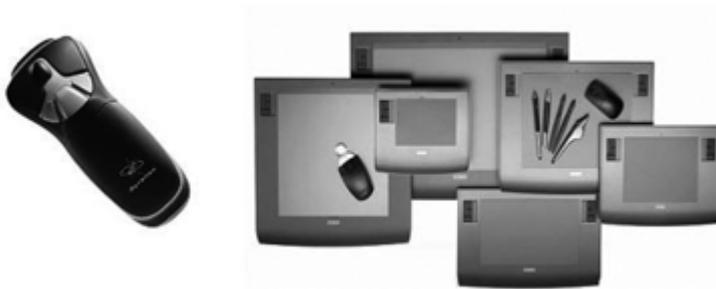
Ilustración 9. Ratón inalámbrico para manejo en el escritorio o en el aire y gama de tabletas digitalizadoras.
