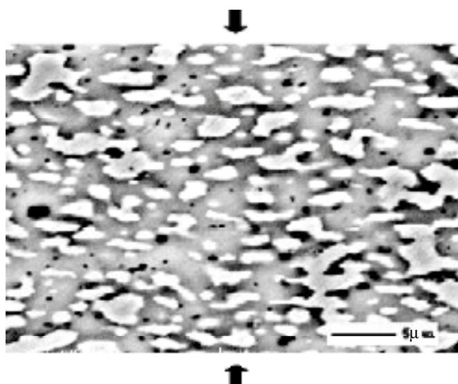
Fig. 8-Micrografía MEB a bajos aumentos del compuesto deformado ( 9.5-14 MPa; 1250-1200 °C). El eje de compresión se indica con flechas.
