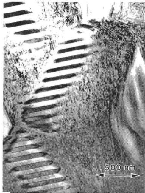
Fig. 6.—Morfología de los precipitados tetragonales en los sistemas ZrO_2 -MgO (a), ZrO_2 -CaO (b) y ZrO_2 - Y_2O_3 (c); Los primeros estados de precipitación para el ZrO_2 - Y_2O_3 se muestran en la figura 2.
