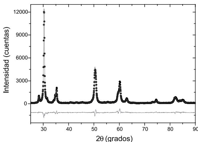
Figura 3. Difractograma de la muestra de circona dopada con calcia. Los puntos representan los datos de difracción de rayos X y la línea sólida el espectro calculado mediante el modelo de mejor ajuste obtenido tras la aplicación del método de Rietveld. La línea sólida inferior constituye el perfil de diferencias (intensidad observada menos calculada).
