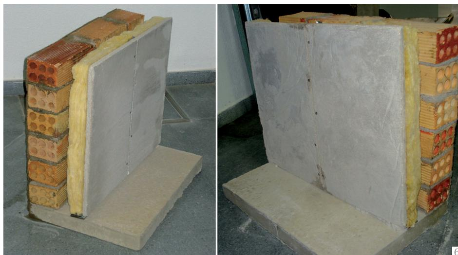
En el prototipo se ha realizado la unión de dos paneles en un mismo montante por tratarse de la unión más desfavorable, ya que las distancias entre la línea de atornillado y el borde lateral del panel es mínima. De este modo se ha conocido la dureza y resistencia límite de atornillado de los paneles.
