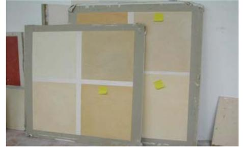
Figuras 7 y 8. Muestras de ensayo de color con mortero de estuco sobre placas de cartón-yeso.
