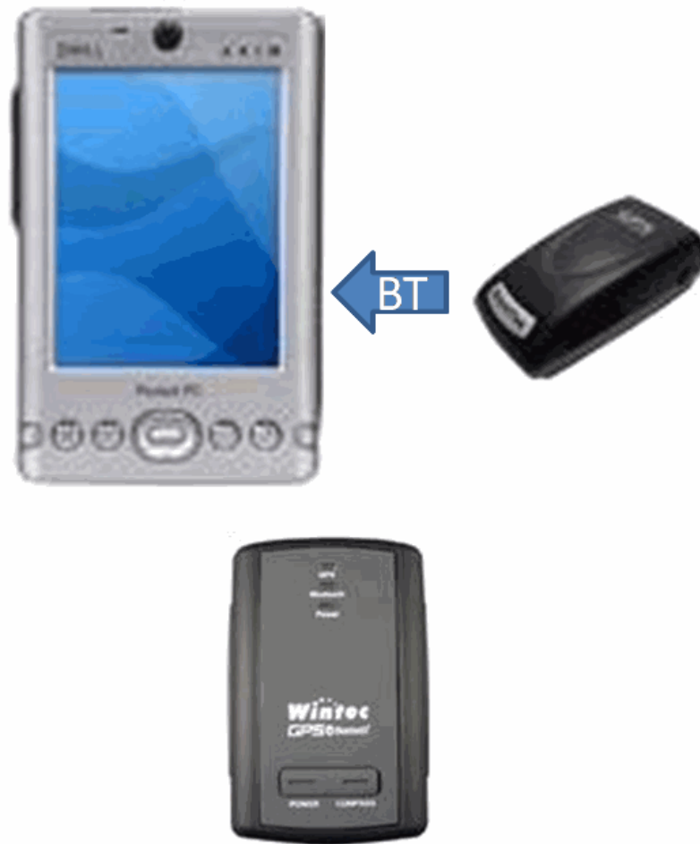
Figura 2.2: PDA y receptores GPS utilizados en la fase de recuperación de recorridos.
