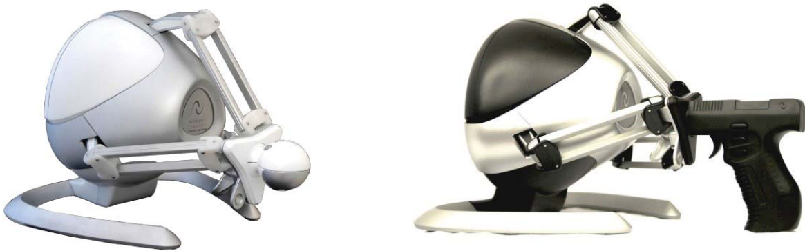
Figure 3.1 Le joystick haptique Falcon avec différents effecteurs : à gauche il s'agit de l'effecteur standard qui vient à l'achat de l'appareil, à droite, le poignet pistolet pour les jeux vidéo
