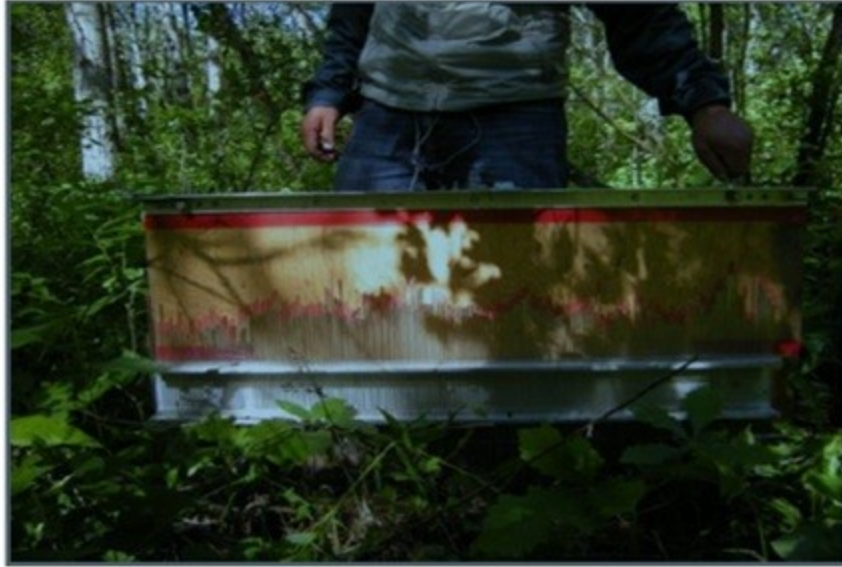
Figure 3.2 : Mesure de la rugosité de surface du sol sur le site forestier F2
