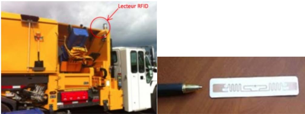
**Figure 5.9** Camion de collecte automatisée avec lecteur RFID et transpondeur RFID sur bac (Bourg et Nafekh, 2015, p. 5)
