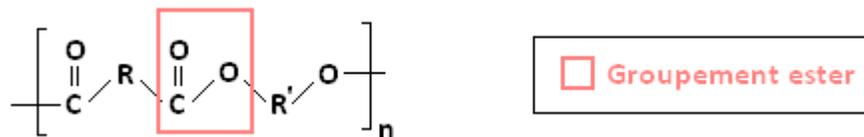
Figure 2-6 : Structure chimique d'une résine polyester
