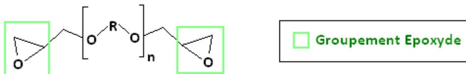
Figure 2-3 : Structure chimique d'une résine polyépoxyde
