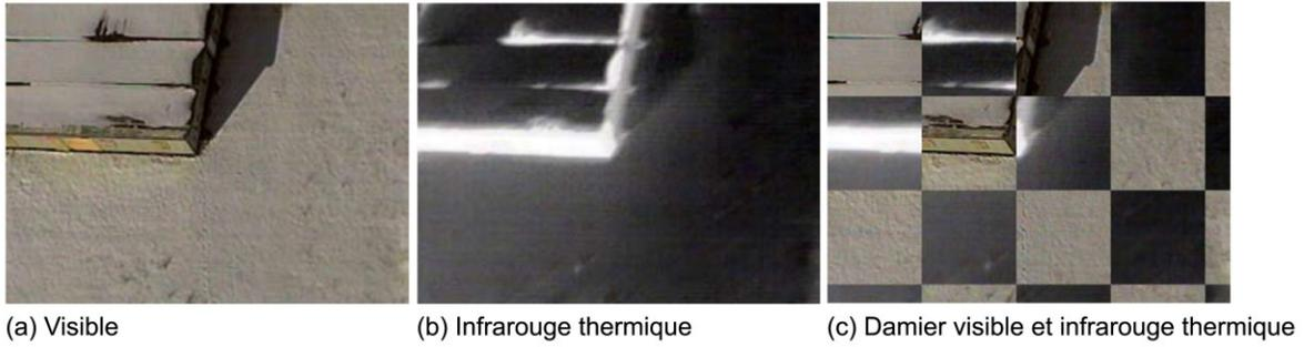
**Figure 4. Exemple d'une image visible, de son homologue infrarouge thermique et d'un aperçu en damier et la superposition des deux images [Modifié de Rasmussen *et al.* (2009)]**
