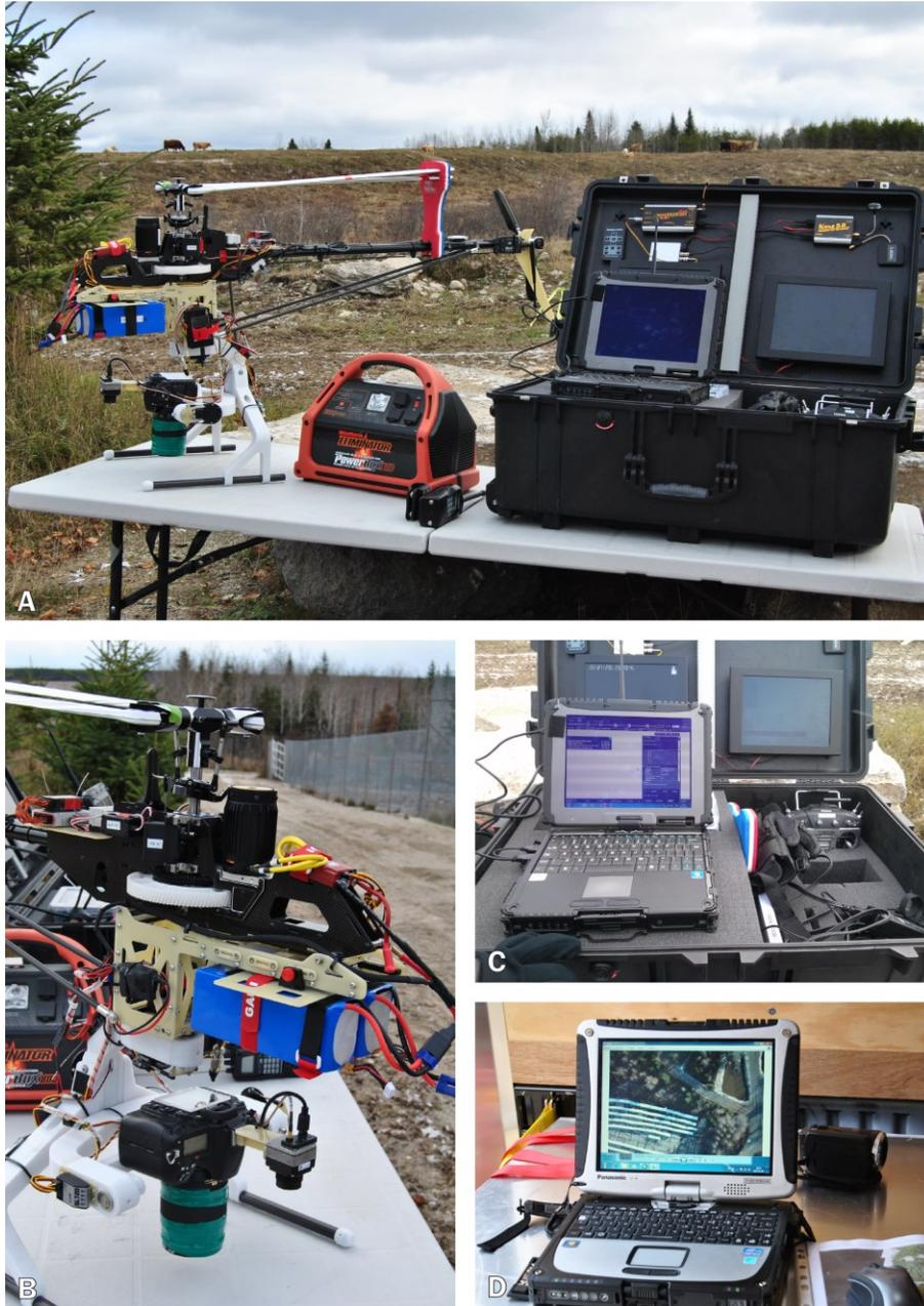
**Figure 13. Système d'aéronef sans pilote. A. ASP et sa station de contrôle au sol. B. Système d'imagerie visible et infrarouge thermique. C. Ordinateur de la station de contrôle au sol. D. Ordinateur dédié à l'imagerie.** Source : L.-P. Chrétien et CGQ.
