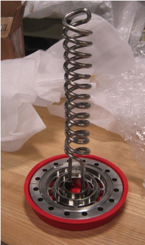
Figure 28: Aperçu du tuyau de refroidissement nettoyé et soudé
