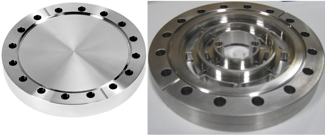
Figure 26: Aperçu de la pièce brute et de la pièce usinée
