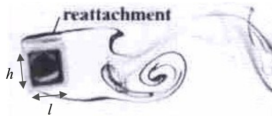
Figure 2.3 : Visualisation expérimentale de l'écoulement autour d'une section carrée à Re = 250 et \alpha = 6 degrés [Luo et coll., 2003].
