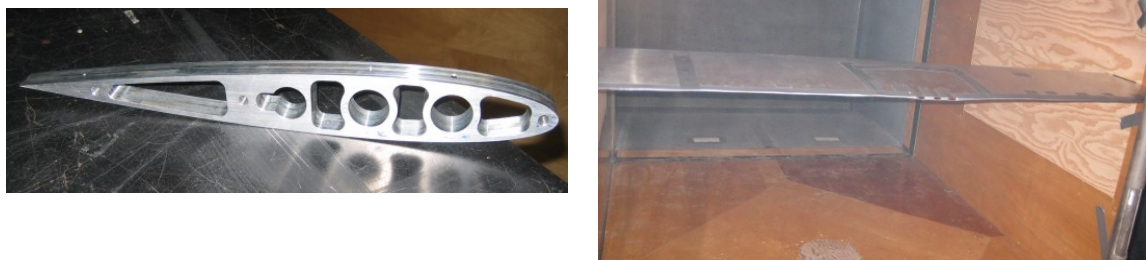
Figure D.1: Aile NACA 0012 servant à injecter la fumée dans la soufflerie
