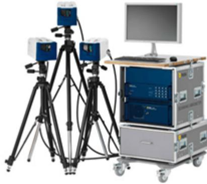
Figure 4.15 Vibromètre laser PSV-500-3D-M de Polytec
