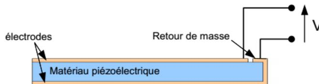
Figure 2.7 Coupe schématique d'un PZT circulaire
