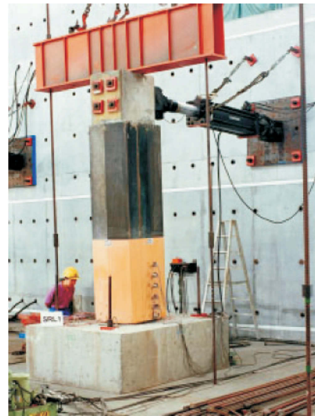
(b) Étude d'un pilier renforcé par un chemisage en acier (Min-Lang, Lin et al, 2010 [37]).
