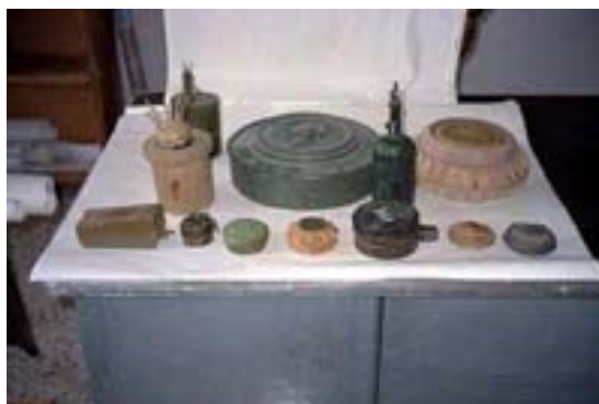
Figure 1.2 Différents types de mines anti-personnel terrestres trouvées en Irak. Tirée de l'ONU, 2009
