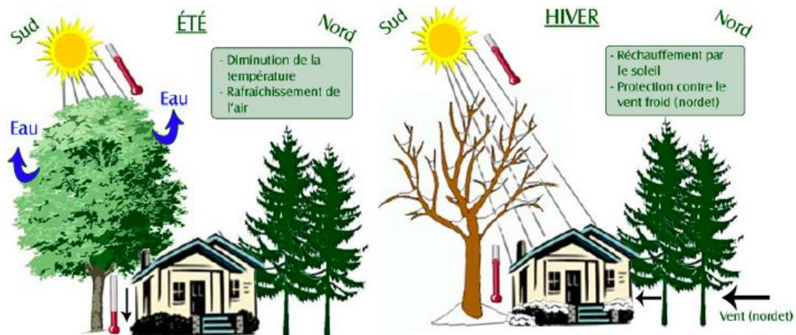
Figure 3.2 : Emplacement de la végétation et la balance thermique d'un bâtiment (Tiré de : Lessard et Boulfroy, 2008, p. 11).
