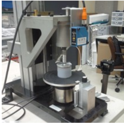
Figure 6.8 Analyseur mécanique quasi-statique (QMA)
