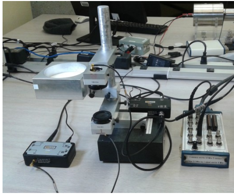
Figure 6.5 Tortuosimètre à transmission ultrasonore (UTM)
