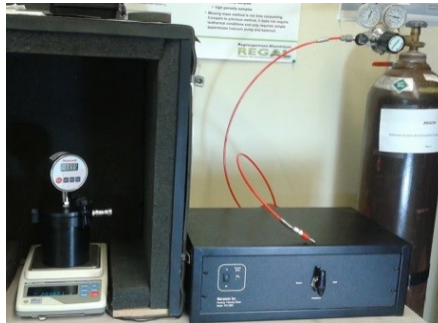
Figure 6.2 Chambre à vide, capteur de pression, bonbonne à Argon et balance à haute sensibilité
