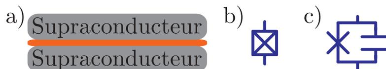
**FIGURE 1.1** Jonction Josephson. a) Schéma d'une jonction Josephson, soit deux supraconducteurs séparés par une mince couche isolante. b) Symbole utilisé pour représenter une jonction Josephson dans un circuit électrique. c) Autre symbole utilisé pour représenter une jonction Josephson dans un circuit électrique. Le « X » représente l'inductance non linéaire tandis que le condensateur représente la capacité entre les deux supraconducteurs.
