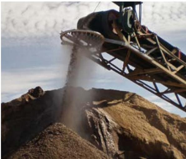
**Figure 4.6 : Diffuseur circulaire à eau pour tête de convoyeur-empileur (DustBoss, s. d.)**
