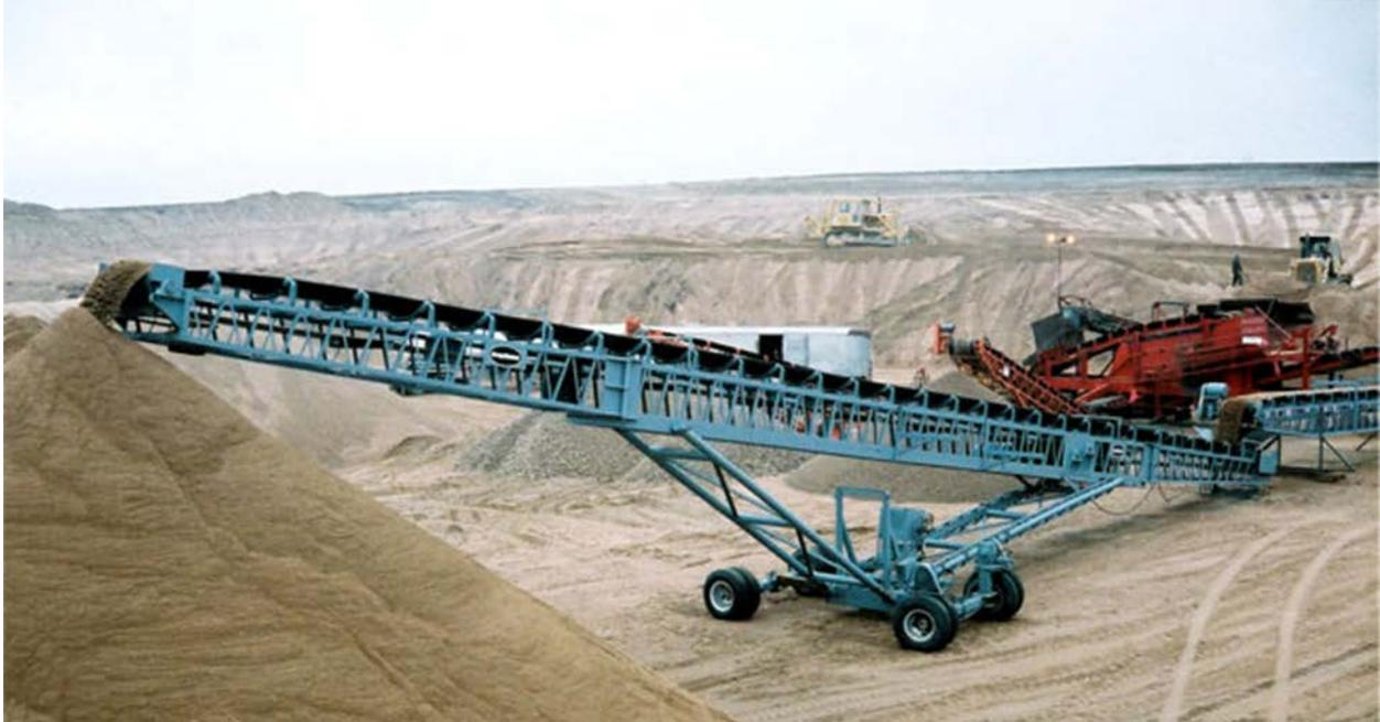
**Figure 1.2 Convoyeur-empileur radial** (Tiré de : Graystone inc., 2015)
