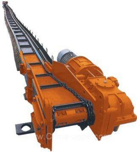
**Figure 4.3 : Convoyeur à chaîne** (ChinA-ogpe.com, 2015)
