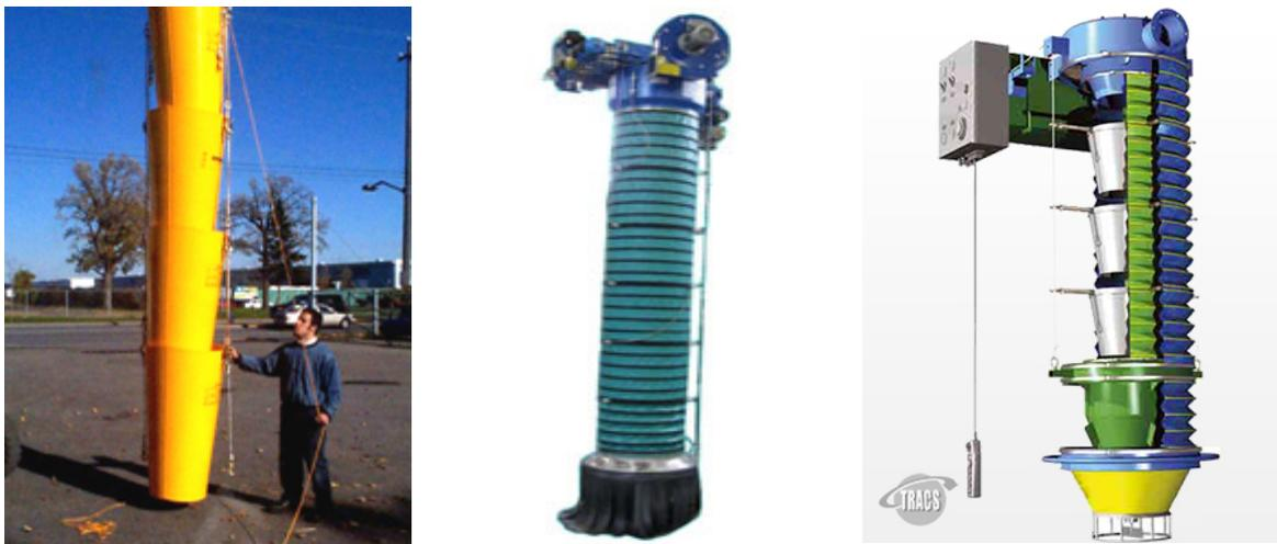
**Figure 4.7 : Goulottes télescopiques** (Superchutes®, s. d.; Thenex®, 2015; Tracs, s. d.)
