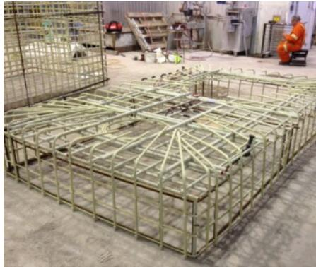
Figure 4-2 : Cage de PRFV pour les chambres souterraines en PRFV
