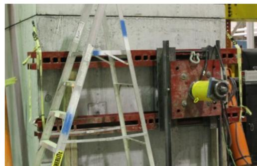
Figure 4-5 : Schéma du montage expérimental à gauche et photo présentant le montage réel à droite pour les essais de traction directe
