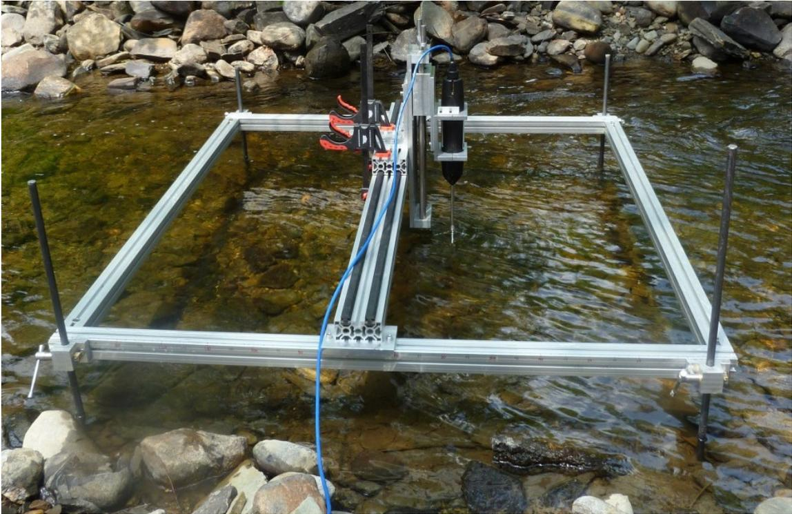
**Figure 3.1– Support de terrain en place pour la collecte de données avec l’ADV**
