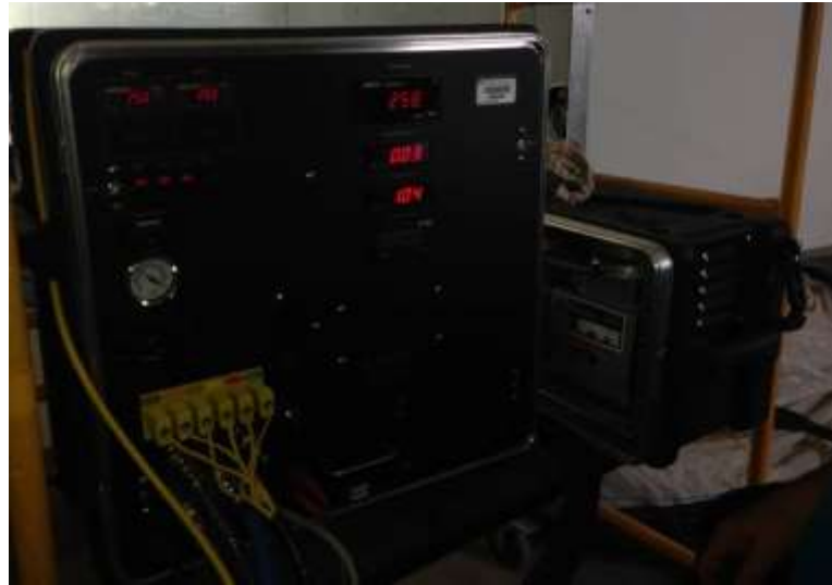
Figure 3.15 Équipement d'échantillonnage XC-563 et pompe à diaphragme
