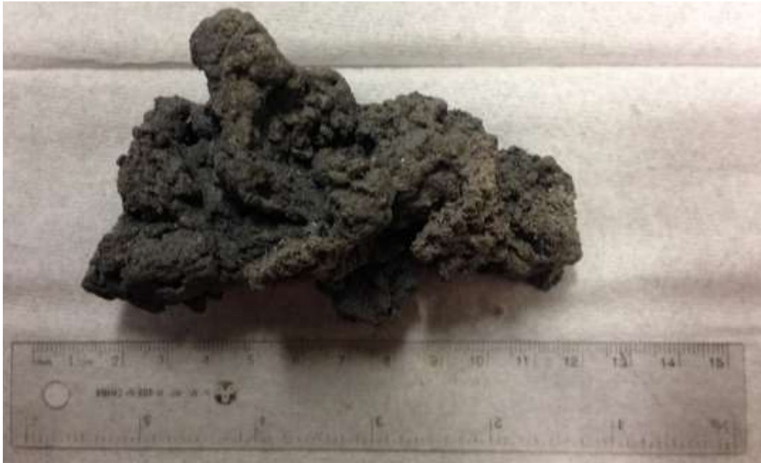
Figure 6.2 Mâchefer produit durant l'un des essais de combustion de l'alpiste roseau
