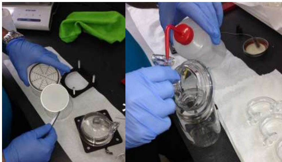
3. Retirer à l'aide d'une pince le filtre et le déposer dans sa boîte.
