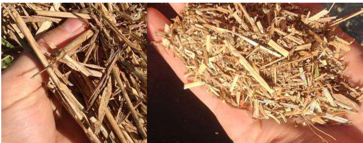
Figure 3.6 Granulométrie avant (gauche) et après (droite) le déchiquetage du miscanthus
