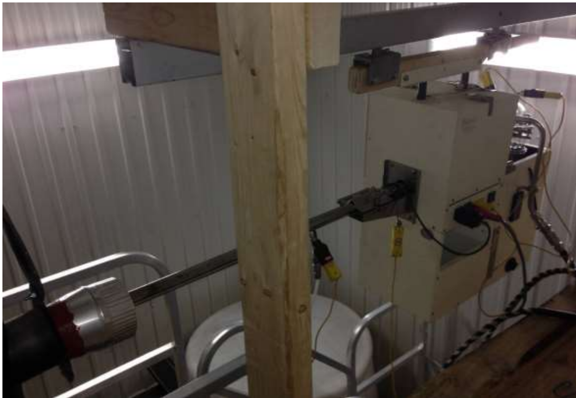
Figure 3.16 Chariot de prélèvement de la sonde aux impacteurs
