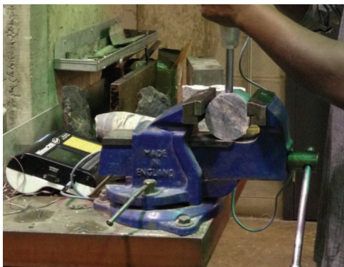
Essai réalisé sur la génératrice pour déterminer le JCS des joints non altérés
