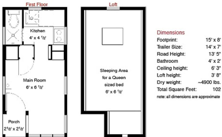
Figure 3.2 Exemple d'une micromaison (vue plan) (tiré de : *Tiny House Talk*, 2010)
