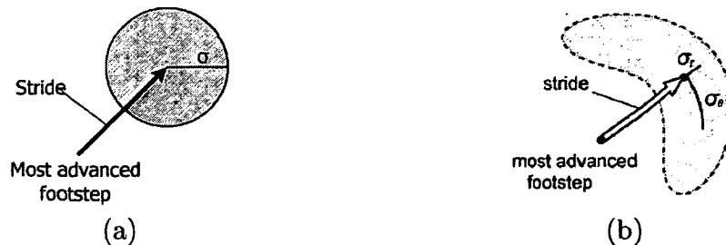
Figure 2.6 Modèle de prédiction pour la méthode MCMC : (a) gaussien, linéaire (b) bipède, non linéaire (source : [28]).
