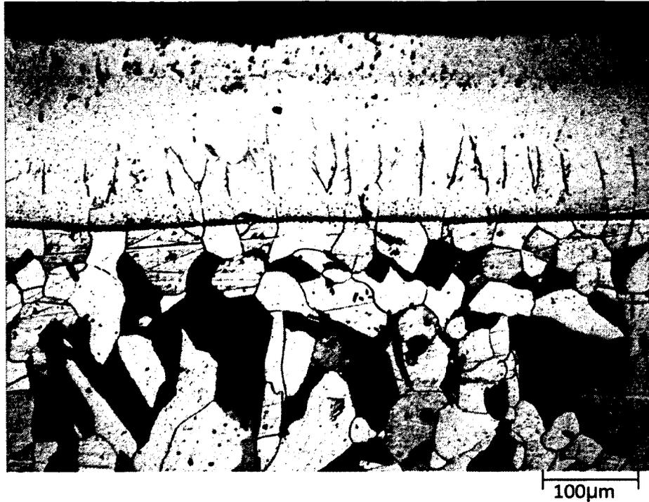
Figure 7.16 : Métallographie de la surface supérieure de la barre collectrice du test E4 montrant la couche Fe-Al
