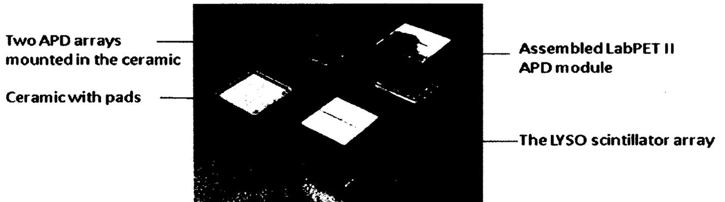
Figure 4.1 : Module photodétecteur du LabPET II [71]
