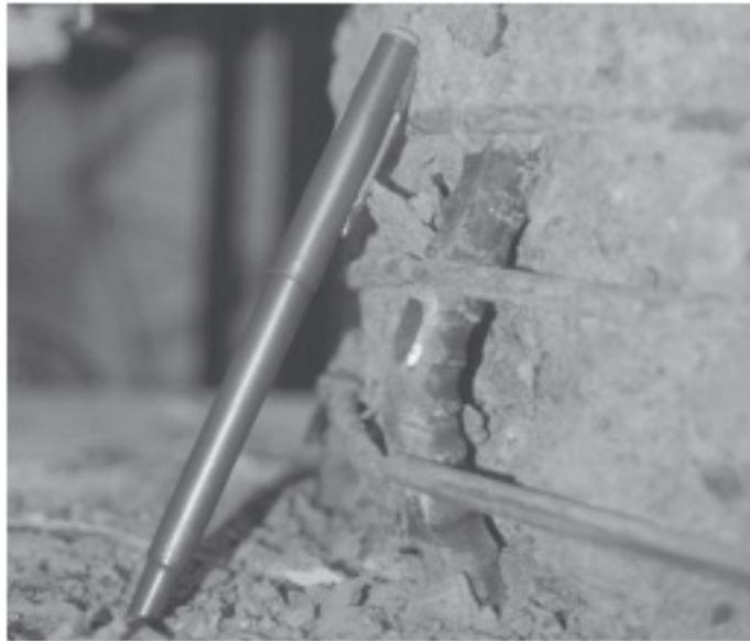
Figure 2.4 Flambement de barres longitudinales (Lehman et Moehle, 2000)
