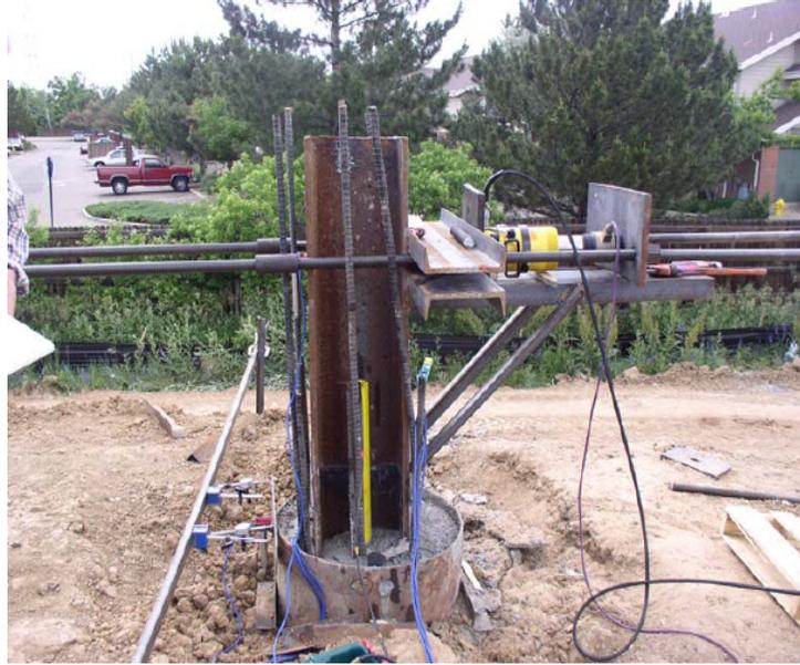
Figure 5.2 Photo réelle de l'essai de chargement latéral au site I-225 près de la 6<sup>ème</sup> avenue que la charge est appliquée. Le déplacement latéral du pieu est mesuré à l'aide du dispositif SINCO indicateur de pente, tous le 0,7 m le long du pieu.
