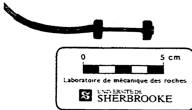
Figure 6.4 Jauge à fibre optique utilisée dans la conception de la cellule de déformation à fibre optique
