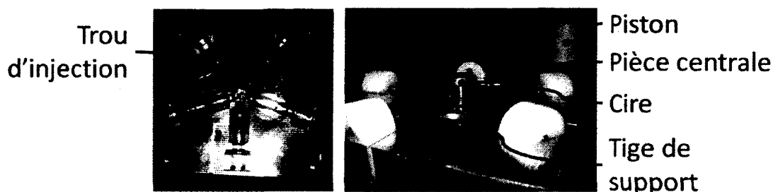
Figure 4.10 Moule en deux parties et composants principales
