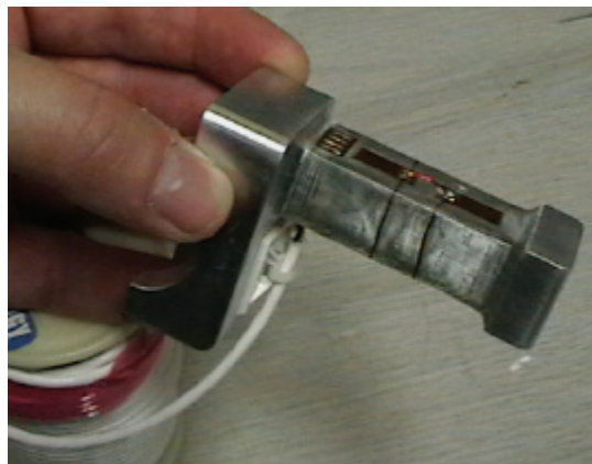
Figure 8-3 : Visualisation des jauges installées sur le corps d'épreuve de la cocotte instrumentée
