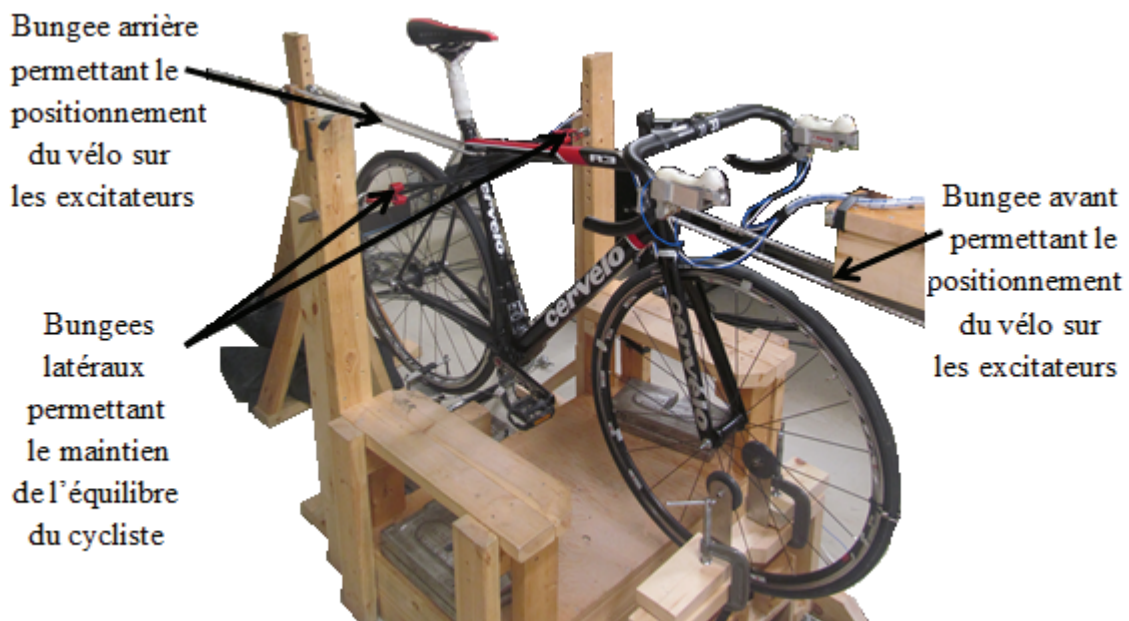
Figure 5-11 : Visualisation de la configuration qui permet de maintenir le vélo en place sur les excitateurs hydrauliques à l'aide de bungees
