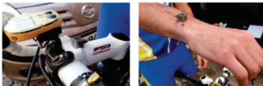
Figure 2-7 : Accéléromètre sur la potence (Gauche) et sur le poignet (Droite) (Chiementin et al. , 2013)
