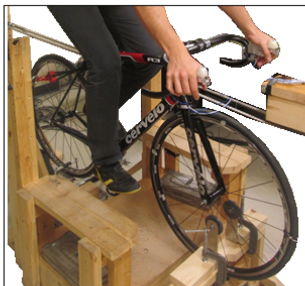
Figure 5-3 : Illustration du positionnement du cycliste lors des mesures de puissance à la main à l'aide de la cocotte instrumentée
