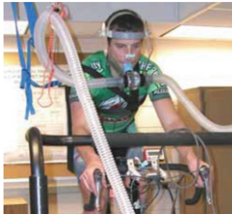
Figure 2-2 : Appareil permettant de mesurer la consommation d'oxygène du cycliste (Hastings et al. , 2004)
