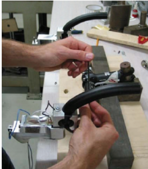
Figure 8-4 : Installation des cocottes instrumentées sur un cintre
