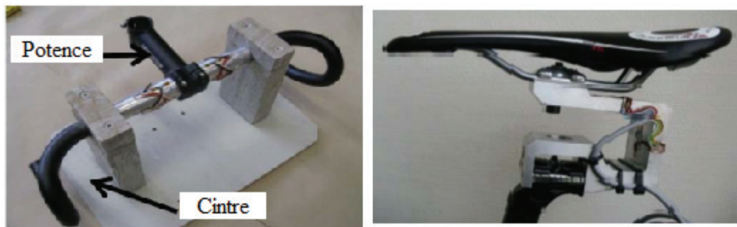
Figure 2-5 : Cintre instrumenté avec des jauges (Gauche) et insert de selle instrumenté avec des jauges (Droite) pour détermination de la force au niveau du cintre et de la selle (Vanwalleghem et al. , 2012a, 2012b)
