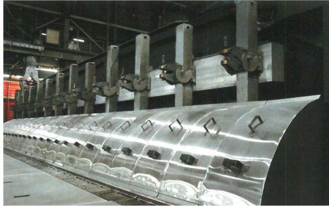
**Figure 1.3** Cuve d'électrolyse de technologie AP60 (Rio Tinto Alcan) [Allais, 2013]
