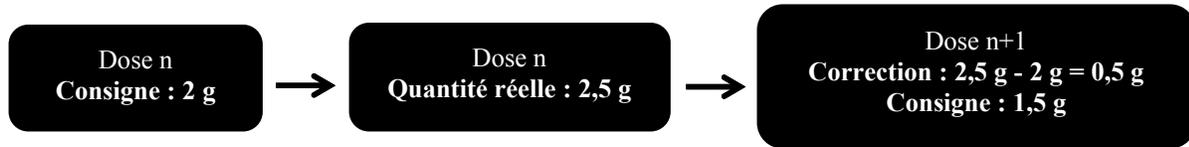
Figure 3.4 Correction du dosage d'alumine
