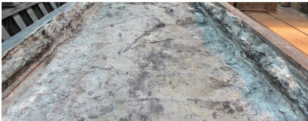
Figure 3.6 Surface d'une cellule d'électrolyse industrielle avant l'autopsie
