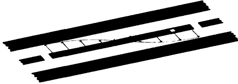
FIGURE 2.2 - Résonateur coplanaire non linéaire ajustable. Le résonateur devient non linéaire par l'ajout d'une jonction Josephson à même le conducteur central. S'il s'agit plutôt d'un SQUID tel qu'illustré sur cette figure, le résonateur est non linéaire et sa fréquence est ajustable. La flèche double indique que l'ajustement de sa fréquence déforme légèrement les modes de résonance et déplace les noeuds.
