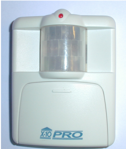
Figure 2.1: Détecteur de mouvement sans-fil
