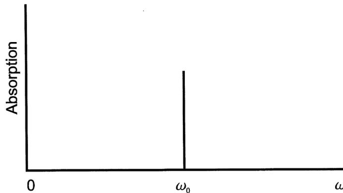
**Figure 3.** Spectre d'absorption RMN d'un système de spins non couplés.
