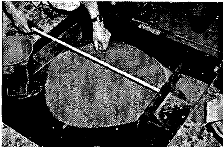
Figure 3.11 Mesure de l'étalement du BAP [Swedish Concrete Association, 2002]
