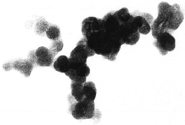
Figure 5.11 : Micrographie d'un agrégat de noir de carbone produit axialement (MET- 1 mm = 7.4 nm).
