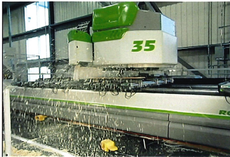
Figure 1.1 - Centre d'usinage (défonceuse) Biesse Rover 35, moteur 30000 tr/min.
