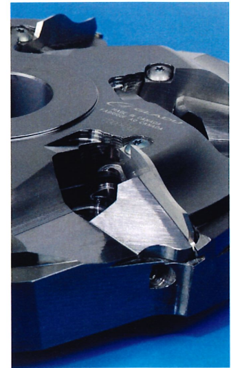
Figure 5.5 - Fraise pour l'usinage à grande vitesse des panneaux ravalés.
