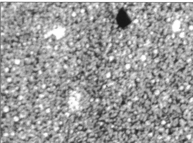
Figure 7.5 : Photographie du bitume-caoutchouc e15 agrandie 500 fois
