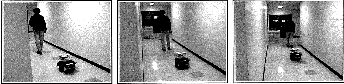
Figure 4.1 Robot suivant une personne à l'aide du dispositif ultrasonique
