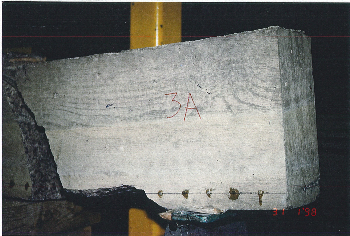
Figure 5.24 Vue de la rupture de la poutre 3A
