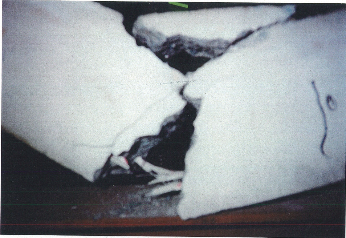
Figure 5.34 Rupture en tension des armatures PRFG
