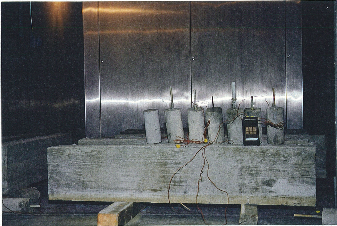
Figure 4.14 Vue des poutres dans la chambre environnemental permettant aux poutres de subir des cycles de gel/ dégel.
