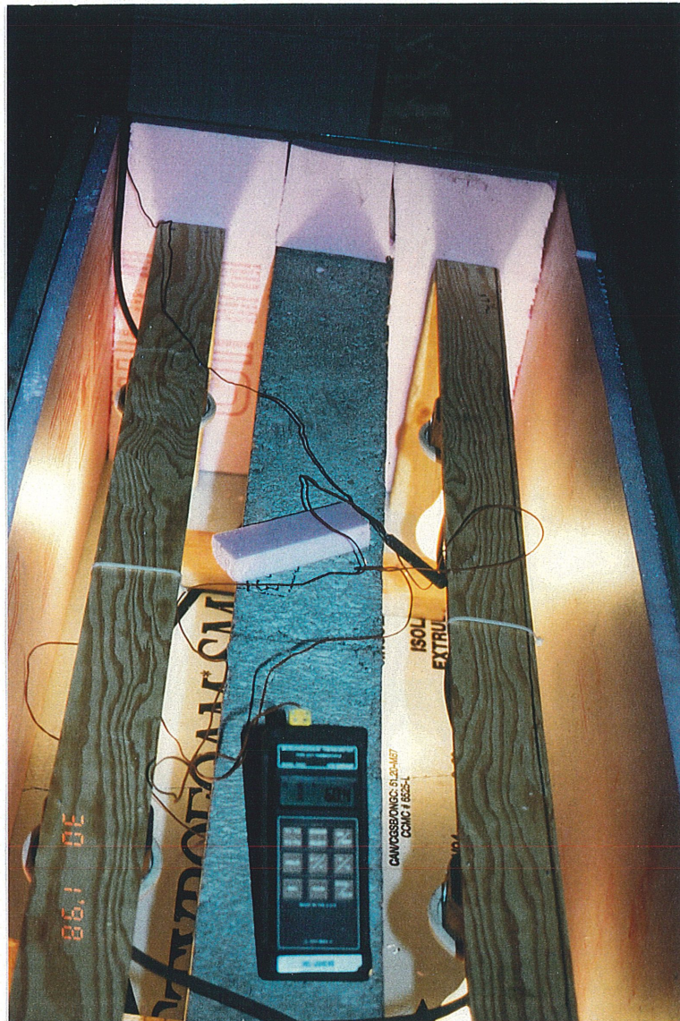
Figure 4.13 Chauffage de la poutre dans une enceinte isolée à l'aide lampes puissantes (200W)
