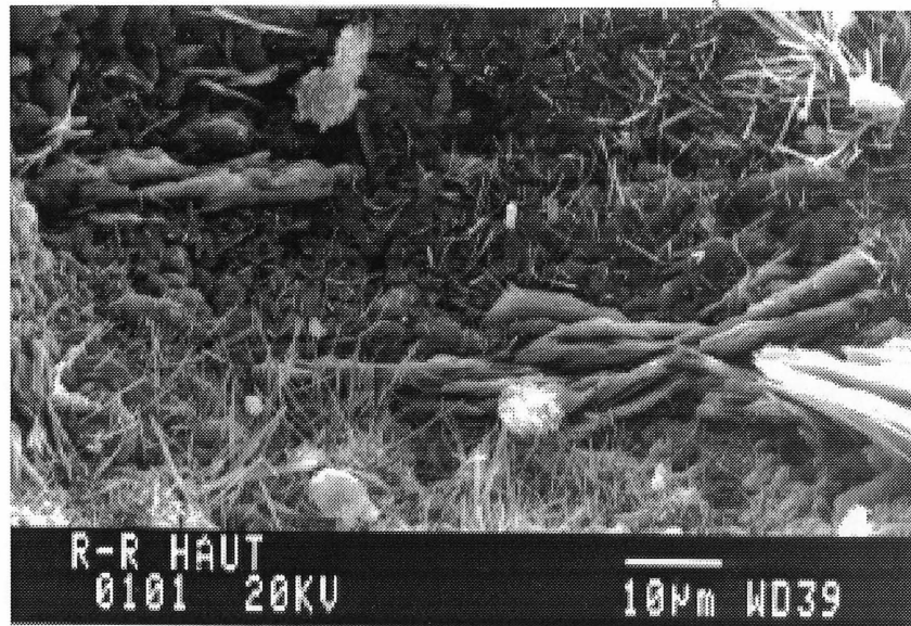
Figure 4.75 - Produits d'hydratation dans une bulle d'air de la pâte contenant du Rheomac en concentration faible et du Rheobuild à 7 jours d'hydratation
