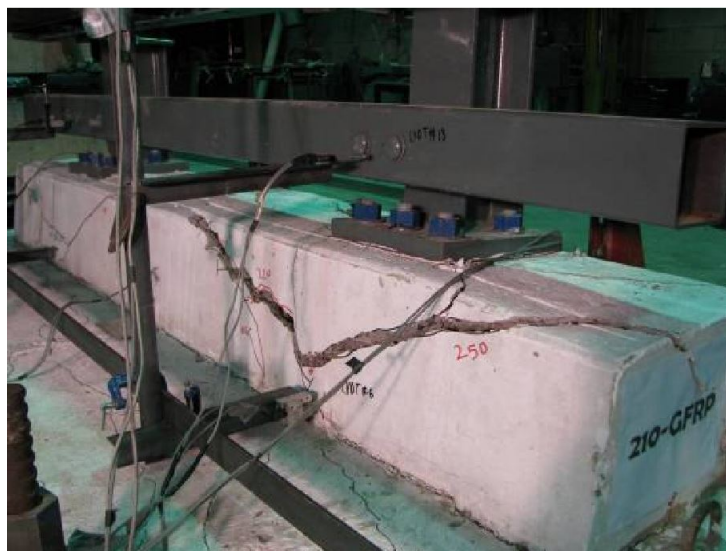
Figure 3.10 Rupture du spécimen 210-PRFV-G1 (étriers fermés), [Benmokrane et al. , 2009]
