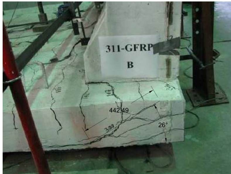
Figure 6.9 Dimensions de la fissure du dispositif MTQ-311 pour fins de calcul, [Benmokrane et al. , 2009]
