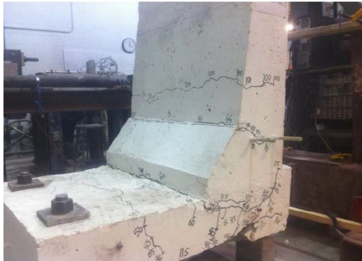
Figure 2.12 Mode de rupture du dispositif de niveau PL-3 testé par Khederzadeh et Sennah, [Khederzadeh et Sennah, 2013]
