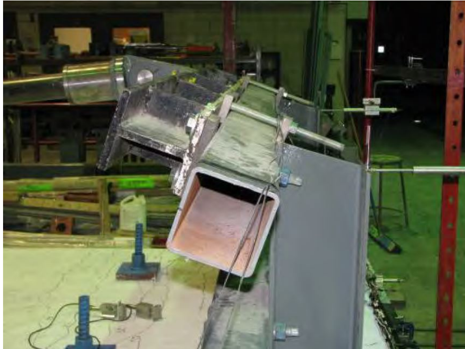
Figure 3.27 Rupture par flambage de la soudure avec le poteau du dispositif S-1642, [Ahmed et al. , 2010]
