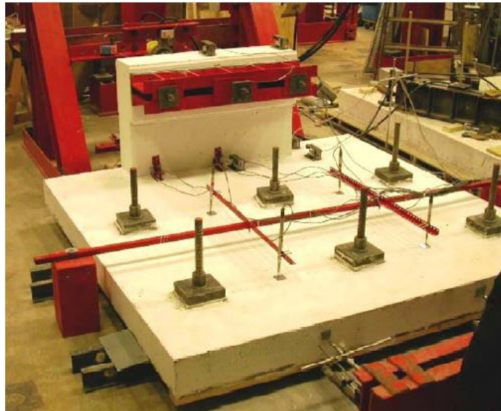
Figure 2.8 Dispositif de retenue testé par l'équipe de Matta et Nanni en 2009, [Matta et Nanni, 2009]
