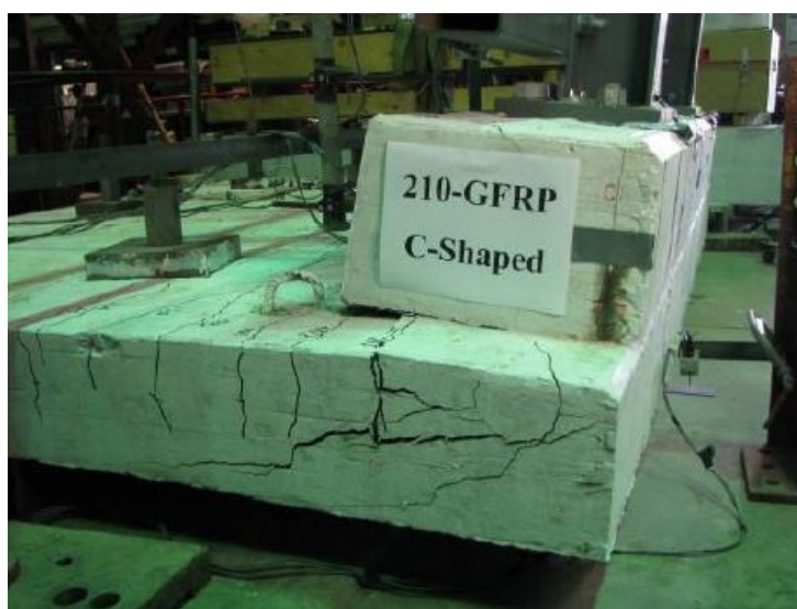
Figure 3.11 Rupture du spécimen 210-PRFV-G2 (étriers ouverts), [Benmokrane et al. , 2009]
