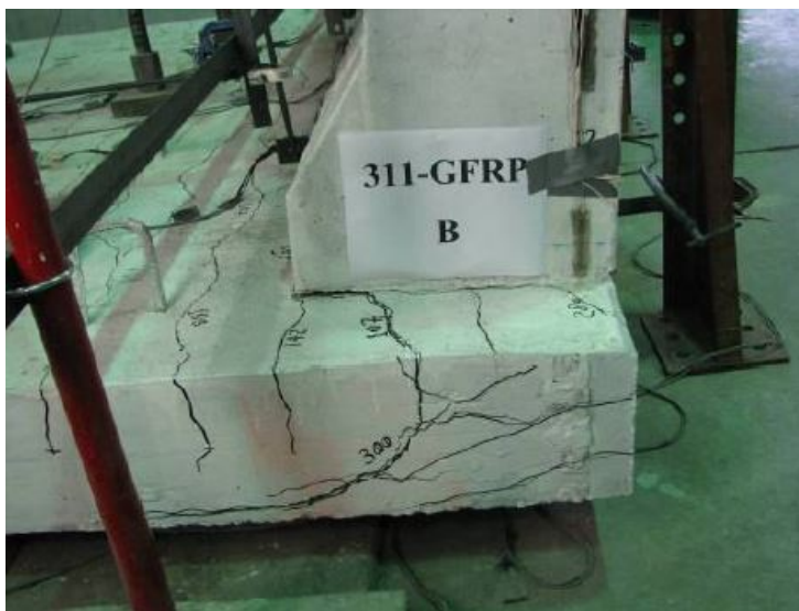
Figure 3.21 Rupture du spécimen 311-PRFV-2 (PL-2), [Benmokrane et al. , 2009]
