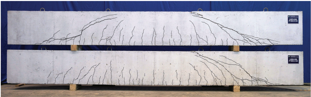
Figure 6.1 Poutres LBP0.5S0 (haut) et LBS0.5S0 (bas) après les essais à la rupture
