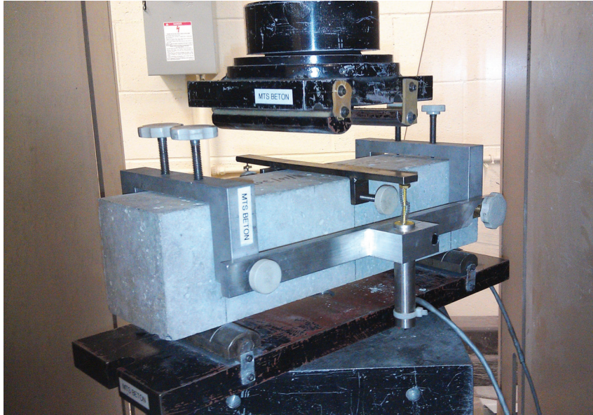
Figure 4.4 Montage pour la réalisation de l'essai ASTM C1609/C1609M-10
