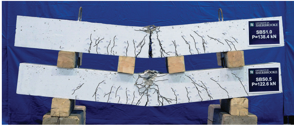
Figure 6.4 Poutres SBS1.0 (haut) et SBS0.5 (bas) après les essais à la rupture
