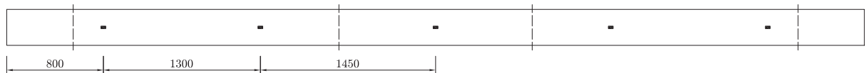
(a) Jauges sur le béton (vue en plan, face supérieure de la poutre)
