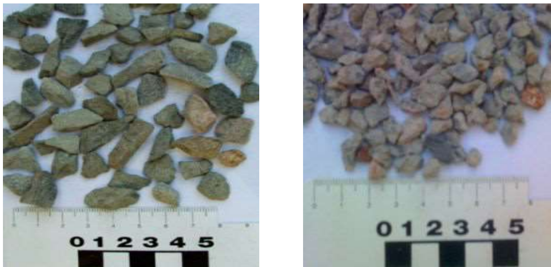
Figura 7 - Ensaio granulométrico utilizando peneira 6,3 mm.
