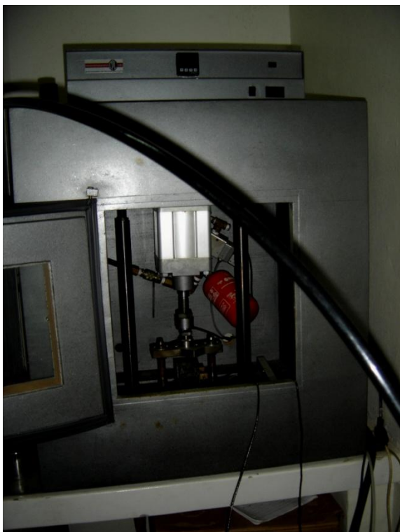
Figura 31 - Ensaio de módulo de resiliência
