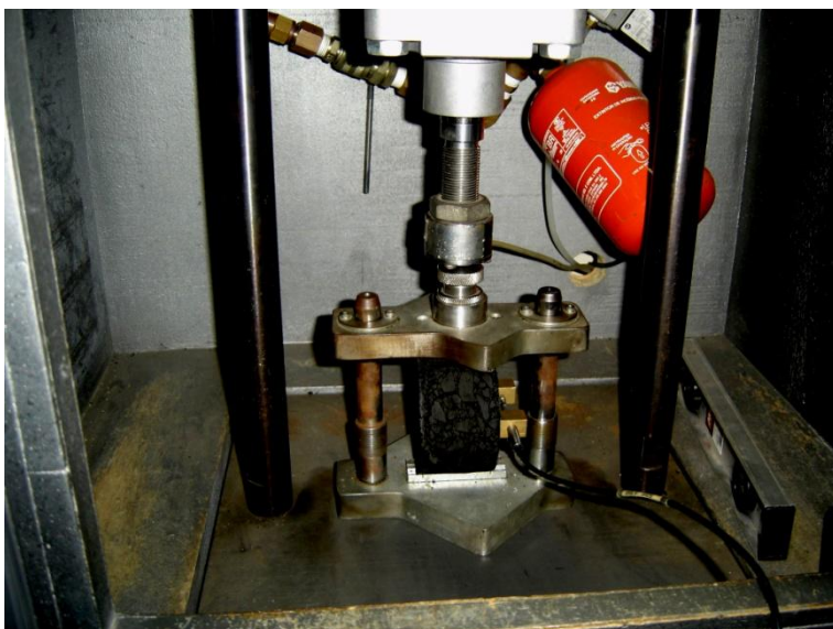
Figura 32 - Ensaio de módulo de resiliência
