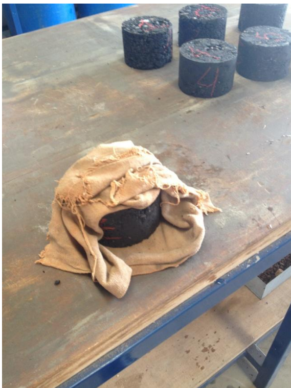
Figura 26 - Pesagem do corpo de prova saturado com a superfície seca
