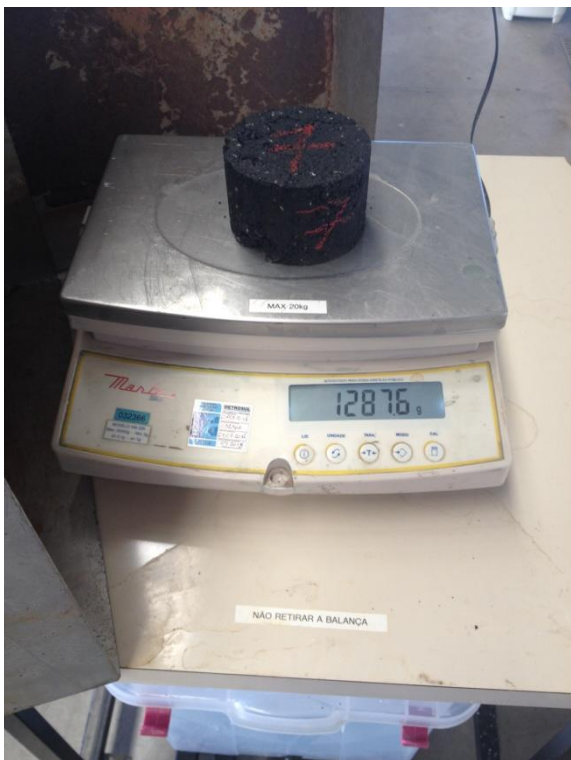
Figura 24 - Pesagem do corpo de prova seco
