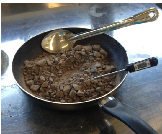
Figura 16 - Aquecimento dos agregados
