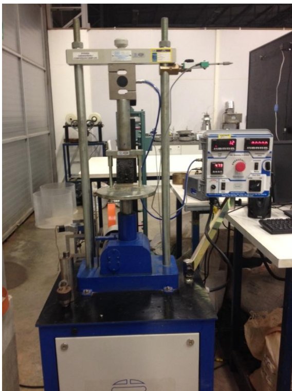
Figura 28 - Ensaio de compressão diametral de corpo de prova cilíndrico
