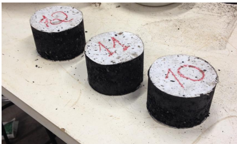
Figura 22 - Corpos de prova prontos em repouso
