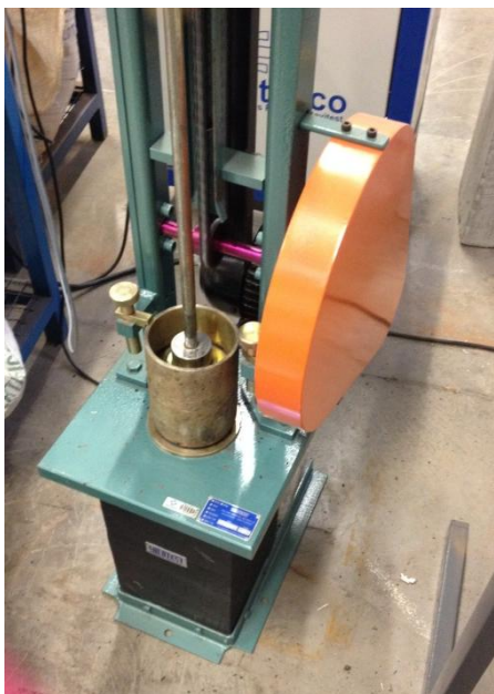
Figura 21 - Compactação da mistura
