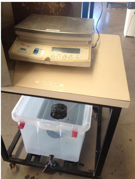
Figura 25 - Pesagem do corpo de prova submerso
