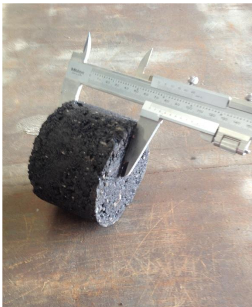
Figura 23 - Medição do corpo de prova
