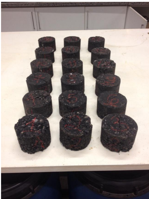
Figura 30 - Corpos de prova rompidos
